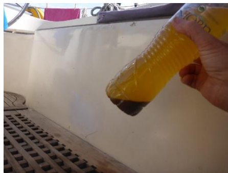
Dårlig diesel, noter skitten vann og møkk i bunnen.
