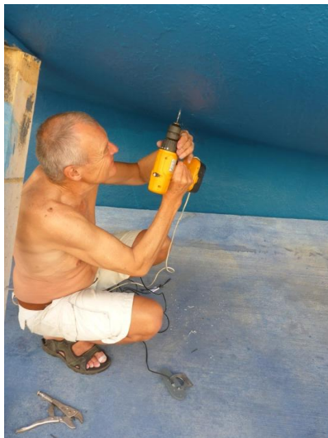
Jens installe un nouveau sondeur
