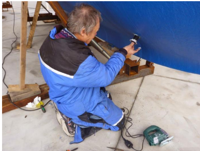
Jens installe un nouveau « log » (compteur)
